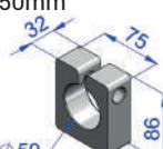
Mancal interno do suporte truck TE e carreta SR Rodoviária - pino Ø50mm
