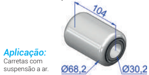
Bucha Ø68 da mola tensora suspensão a ar
