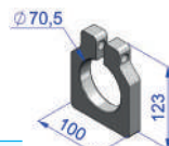
Mancal externo do pino tensor Randon - furo Ø70,5mm
