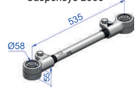
Braço tensor regulável 535mm Suspensys 2000
