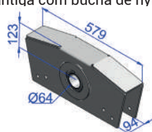
Balança da carreta SR Canavieira Galego antiga com bucha de nylon
