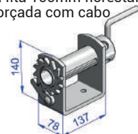
Catraca fita 100mm florestal reforçada com cabo
